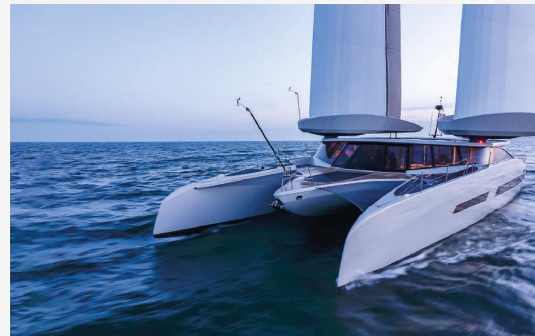
Le MODX 70 est un catamaran à propulsion vélique et électrique, conçu pour naviguer de manière sobre, silencieuse et respectueuse de l'environnement. Doté d'ailes gonflables Aeroforce®, de panneaux photovoltaïques, d'hydrogénérateurs et de matériaux recyclables, il incarne une approche innovante de la mobilité maritime. Sa faible empreinte carbone en fait un allié précieux pour les missions en zones sensibles, comme les Aires Marines Protégées.
