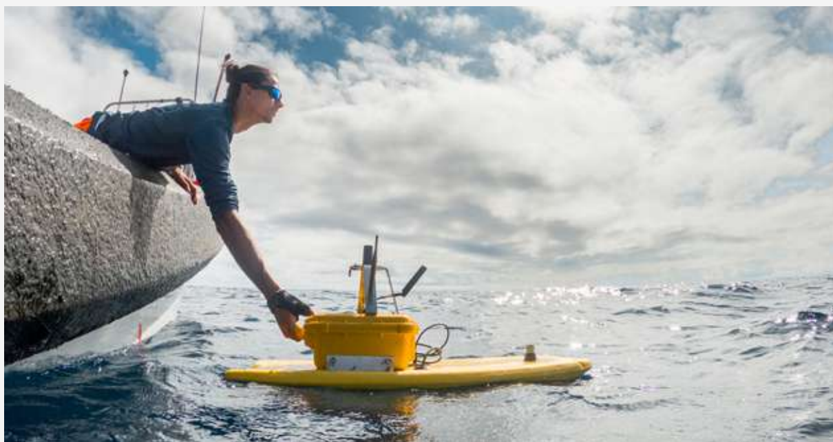
△ Déploiement d'une planche autonome instrumentée sur le banc Saya de Malha © Nicolas Mathys - Zeppelin - Explorations de Monaco
