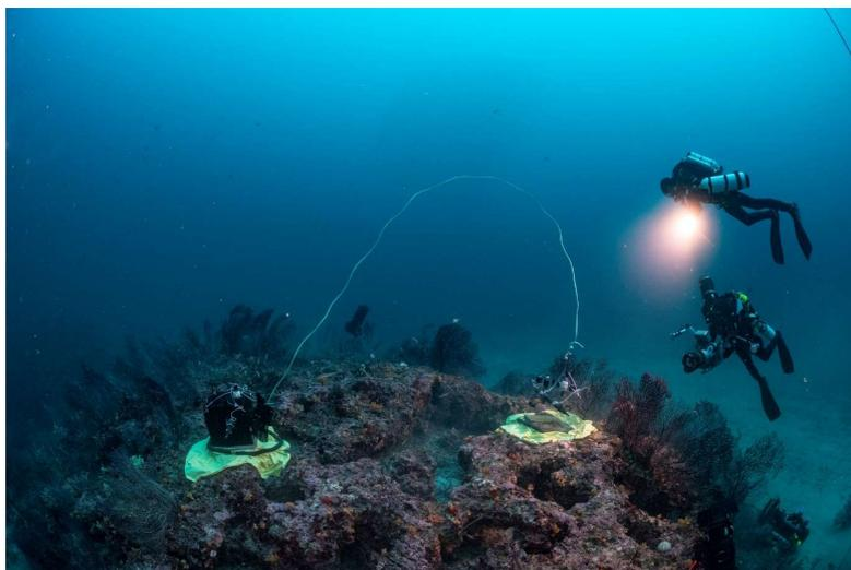
Une chambre benthique opaque (à gauche) et une transparente (à droite) sont posées sur un massif coralligène pour y mesurer les échanges gazeux.
